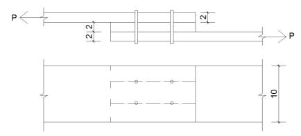
Considerando-se que a tensão de cisalhamento dos parafusos é de 50 MPa e que a tensão de tração da chapa é de 0,7 MPa, qual será o valor máximo de **P**?
