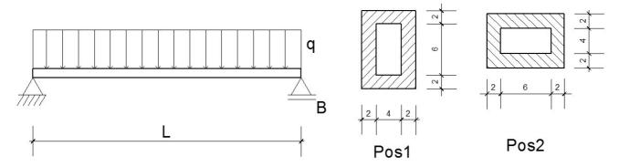
Se esta viga tiver sua posição trocada da posição Pos1 para a posição Pos2 e considerando que a tensão máxima deva ser mantida, o novo valor da carga distribuída será igual a
