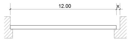
Se o coeficiente de dilatação linear é  $1.5 \times 10^{-5}$  °C<sup>-1</sup>, o comprimento da junta de dilatação, para que a tensão de compressão gerada pela dilatação seja de 10 MPa, será de
