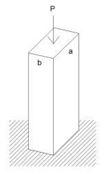
**30.** Observe o pilar de seção vazada mostrado ao lado, engastado na extremidade inferior, livre na extremidade superior e submetido a uma carga centrada no valor de 900 KN, sendo o módulo de elasticidade =  $2.0 \times 10^4$  MPa. A seção do pilar mede 30 x30 cm e o furo, centralizado na seção, mede  $10 \times 10$  cm.
