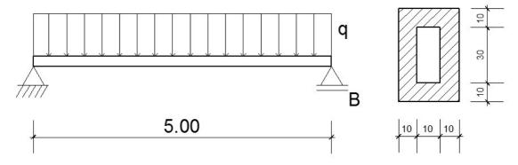
Considerando-se que a tensão máxima na flexão deva ser mantida, se a seção for vazada por um furo de 10x30 cm, conforme mostrado na figura, o vão precisará ser encurtado para
