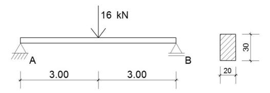
O valor da flecha máxima para a viga abaixo, com módulo de elasticidade =  $2.0 \times 10^4$  MPa, base de 20 cm e altura de 30 cm é
