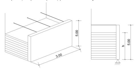
Considerando que os cabos estão submetidos a forças iguais, que têm diâmetro de 1,5 cm e tensão admissível de 80 MPa, a máxima altura de lâmina de água que estes cabos podem resistir é
