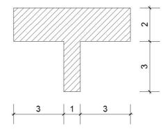
Sendo X um eixo horizontal passando pelo centroide da figura, o valor do raio de giração  $i_{gx}$  é
