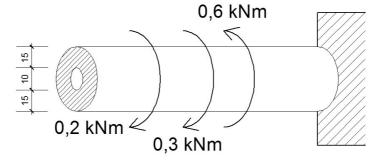
O valor da tensão de torção máxima para o eixo da ilustração é
