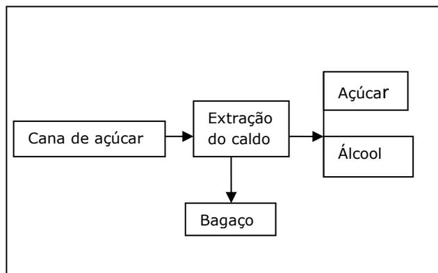
Considerando este processo como uma caixa-preta, temos a cana-de-açúcar como fonte de alimentação que, após a extração do caldo, separa-se em três correntes de fluxo: açúcar, álcool e bagaço. Consideremos o fluxo que entra na caixa preta como  $X_0$ , e os três fluxos de saída como  $X_1$ ,  $X_2$  e  $X_3$ , respectivamente. Suponhamos que o sistema encontre-se em estado estacionário e que nenhum material está sendo destruído ou produzido.
