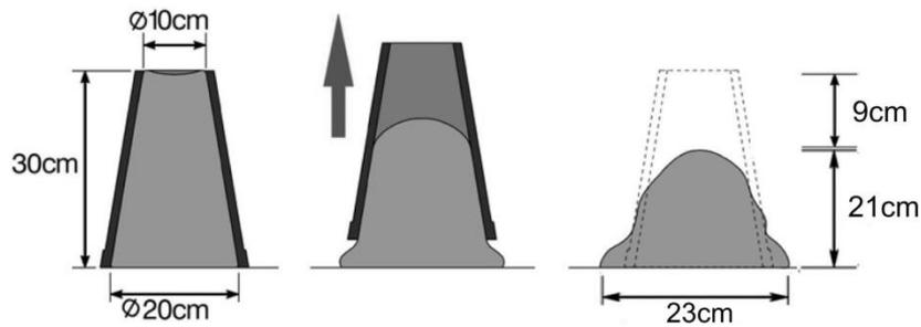
Qual o resultado do abatimento do concreto representado na ilustração acima?
