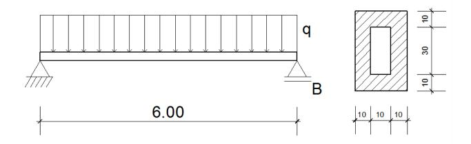
Considerando que a tensão de tração deva ser mantida, se a seção for vazada por um furo de 10x30cm, conforme mostrado, o vão precisará ser encurtado em
