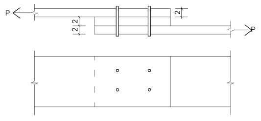
Para o desenho mostrado e considerando que a tensão de cisalhamento dos parafusos é de 100 MPa e a tensão de tração da chapa é de 12 MPa, o valor máximo de **P** será
