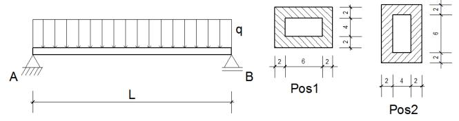
Se esta viga tiver sua posição trocada de Pos1 para a posição Pos2 e considerando que a tensão máxima deva ser mantida, o novo valor da carga distribuída será igual a
