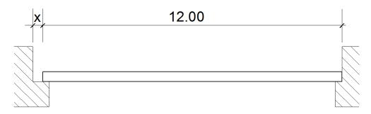
Se o coeficiente de dilatação linear é  $a=1,5 \times 10^{-5}$  °C<sup>-1</sup>, o comprimento da junta de dilatação, para que a tensão de compressão, gerada pela dilatação seja de 15 MPa será
